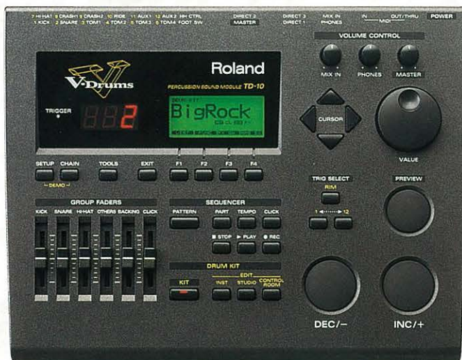
④スタジオの設定 サウンドを決定したら、次はスタジオ設定。基本的なスタジオをはじめ、ビーチ、バスルームなど10タイプの中から選択できる。部屋の大きさは5段階で調節可能。
