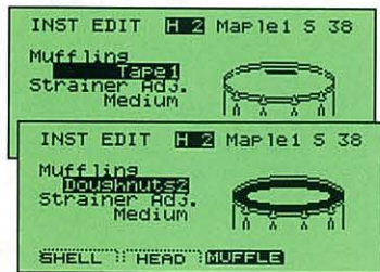
③マフリング(ミュート)/スナッピー スネアではテープ、ドーナツなど、4種類のミュート方法が選べる。その後、スナッピーの張り具合で音質を調節。
