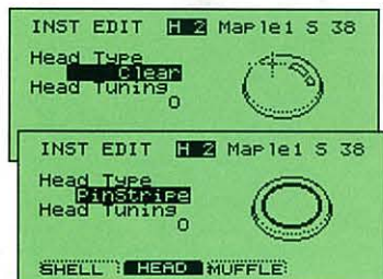
②ヘッドの材質/チューニング ヘッドの材質は、クリア、コーテッド、ビン・ストライプの3タイプ。チューニングもきめ細かい設定が可能。 ※Pin Stripe®は、Remo Inc. U.S.A.の登録商標です。
