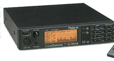
SOUND Canvas SC-55mkII サウンド・キャンバス ¥55,000(税別) ●外形寸法:218(W)×250(D)×48(H)mm ●重量:1.3kg ●付属品:カードリモン NEW PRICE GENERAL MIDI GS
