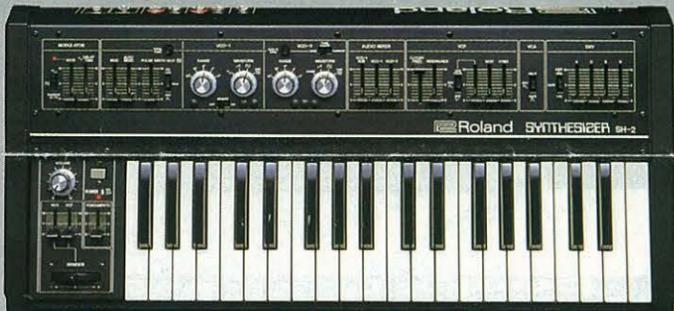
SH-2は2つのVCOを搭載。VCO-1には、従来のノコギリ波、矩形波、非対称矩形波のほか、正弦波がプラスされ、2VCOの持ち味をより生かした音づくりが可能。しかも、サブ・オシレーターをプラスすることにより、3VCOに匹敵する多彩なサウンドが作りだせます。
