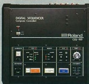
マイクロ・コンピュータ内蔵、最大168音の(84音×2)の音程・リズムを同時にメモリー可能。
