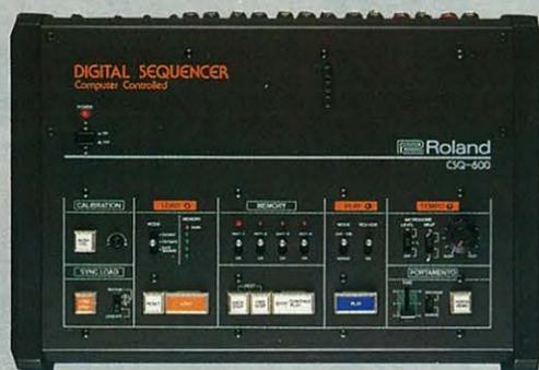
シンセサイザーに接続。鍵盤で弾いた演奏を記憶させ、シンセサイザーを自動プレイ……。CSQ-600は、マイクロ・コンピュータを内蔵し、最大600音の音程とリズムを同時に記憶できる、ハイ・グレードなデジタル・シーケンサーです。
