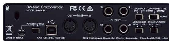
『Rubix24』の背面パネル。メタルボディ、グラウンド・リフト機能、インピーダンス・バランス出力など、細部にわたる低ノイズ設計により高品位な音で録音／再生が可能
