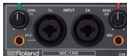
XLR コンボ・ジャック採用の入力部。 ギターやベースを直接挿入できる Hi-Z 入力や コンデンサー・マイク用のファンタム電源に対応
